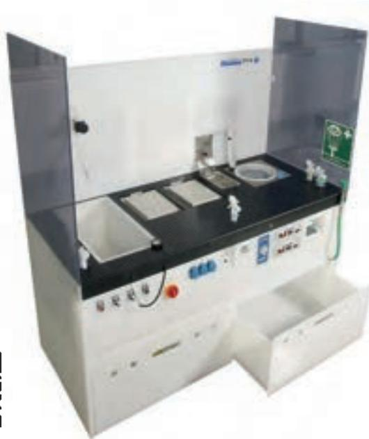
Unsere manuelle Nassbank aus Kunststoff oder Edelstahl ist mit einer elektrisch leitenden und perforierten Arbeitsplatte versehen. Sie verfügt z. B. über Spülbecken, Heizplatten, Ultraschallbad, „Spincoater“ sowie DI-Wasser und N<sub>2</sub>-Brause, Augendusche und Stauraum.
