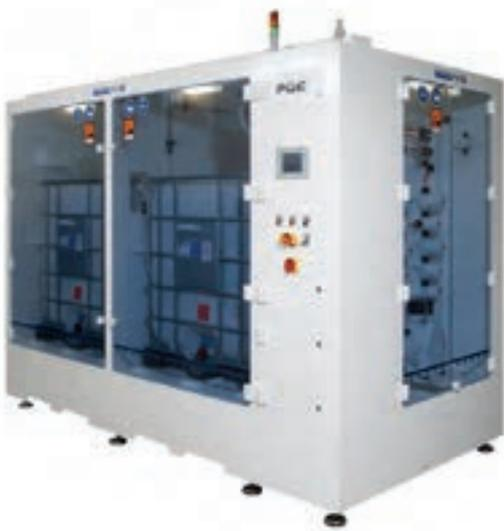
Das Gehäuse der Kabinette besteht aus Kunststoff in PP-weiß mit transparenten PVC-Türen, kann aber auf Kundenwunsch auch mit speziellen, flammhemmenden oder leitfähigen Materialien ausgeführt werden. Die Verwendung von hochwertigen, chemikalienberührenden Materialien (PFA, PTFE, PVDF, PE-HD u. v. m.) garantiert höchste Reinheit der Chemikalien am Point of Use.
