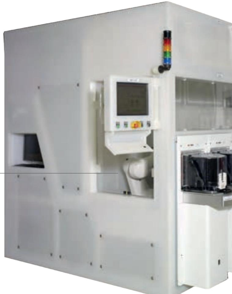
Das Reinigungs- und Ätzsystem kombiniert die neueste Prozesstechnologie mit bewährter Technik bei gleichzeitig höchster Flexibilität. Der modulare Aufbau ermöglicht eine kundenoptimierte Systemkonfiguration entsprechend der benötigten Prozesse und Bearbeitungsmengen. Die im System integrierte Reinraum-Technologie sichert beste Reinigungs- und Ätzprozesse
